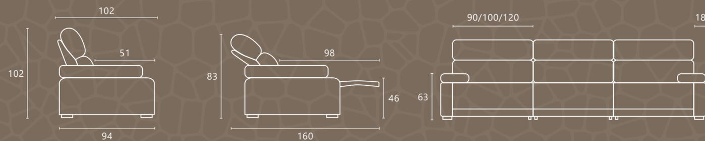
**Estrutura** em madeira de reflorestamento com umidade controlada e imunizada | Nas junções das madeiras estruturais são utilizados **grampos galvanizados** para manter a estrutura firme e resistente | **Mecanismo Touch motorizado** com 1 motor 110-220V | **Espumas** certificadas | **Assentos** com molas zig-zag com espuma D33 confort + D26 soft e manta de fibra poliéster 300gr/m<sup>2</sup> | **Almofadas** fixas preenchidas com fibra siliconada | **Pés** em madeira maciça
