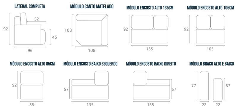
**Estrutura** em madeira de reflorestamento com umidade controlada e imunizada | **Grampos galvanizados** nas junções das madeiras estruturais para firmeza e resistência | **Espumas** certificadas | **Percintas elásticas** esticadas com máquina automática com mola bonel para maior conforto | **Assento** fixo com espuma D33 confort + hipersoft e manta de fibra poliéster 200gr/m<sup>2</sup>, **almofadas** soltas preenchidas com fibra siliconada | **Pés** em madeira maciça
