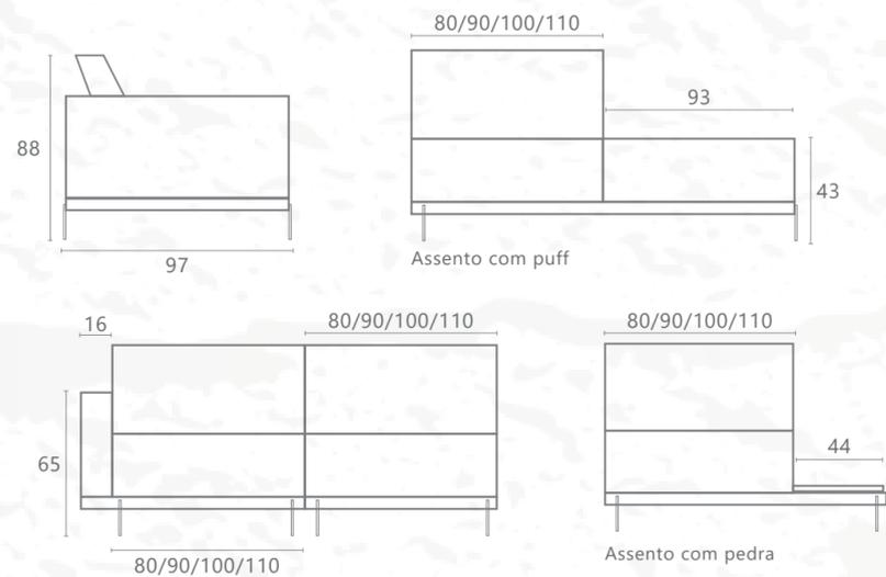
**Estrutura** em madeira de reflorestamento com umidade controlada e imunizada | Nas junções das madeiras estruturais são utilizados **grampos galvanizados** para manter a estrutura firme e resistente | **Espumas** certificadas | **Assentos** em espuma D28 master + fresh, revestida com manta de fibra de poliéster 200gr/m<sup>2</sup> | **Encosto** com almofadas soltas preenchidas com fibra siliconada | **Pés** em aço galvanizado com pintura epóxi | **Detalhe** de mesa lateral com pedra
