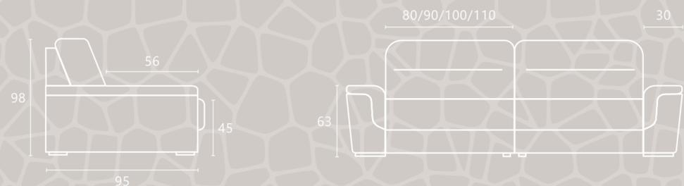
**Estrutura** em madeira de reflorestamento com umidade controlada e imunizada | Nas junções das madeiras estruturais são utilizados **grampos galvanizados** para manter a estrutura firme e resistente | **Espumas** certificadas | **Assento** fixo com molas zig zag com espuma D33 confort + D26 master e manta de fibra de poliéster 300gr/m<sup>2</sup> | **Almofadas** fixas preenchidas com fibra siliconada | **Pés** em madeira maciça
